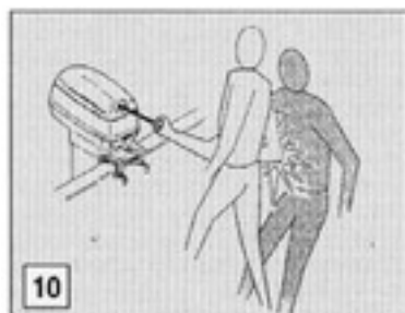
10 อย่าให้มีคนอื่นอยู่ใกล้ ขณะใช้มือกระตุกเพื่อสตาร์ทเครื่อง
