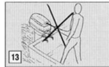
13 ห้ามตั้งสายชักสตาร์ทเครื่อง ในขณะที่เครื่องกำลังทำงาน
